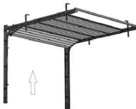
La porte doit manœuvrer en ouverture, si ce n'est pas le cas, inversez les fils du bornier comme indiqué.
